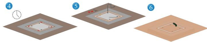
Füllen Sie am Außenrahmen mit Mörtel auf und achten Sie dabei darauf, dass das PVC-Anschlussprofil sauber bleibt. Lassen Sie den Mörtel aushärten. Entfernen Sie das Schutzband von den PVC-Anschlussprofilen am Außen- und Innenrahmen, die Befestigungsschrauben und die Abstandshalter und schrauben Sie die Klemmhülsen an den Hebepunkten ab.
