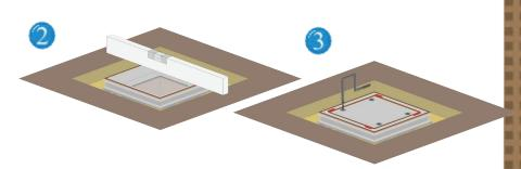
Entfernen Sie die Befestigungsschrauben und nehmen Sie den Innendeckel mit Hilfe der Hebeschlüssel aus dem Außenrahmen. Tragen Sie in der Aussparung am Boden Mörtel auf und setzen Sie den Außenrahmen über der Durchgangsöffnung auf den Mörtel. Richten Sie den Rahmen flächenbündig auf die Höhe des Endbodenbelags aus.
