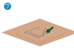
Verschweißen Sie den Bodenbelag mit den PVC-Anschlussprofilen am Außen- und Innenrahmen gemäß den Herstellerangaben.
