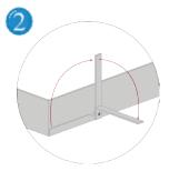
Biegen Sie bei Edelstahlklappen die Befestigungsanker am Außenrahmen um 90° nach oben und falzen Sie sie um 90° nach außen.
